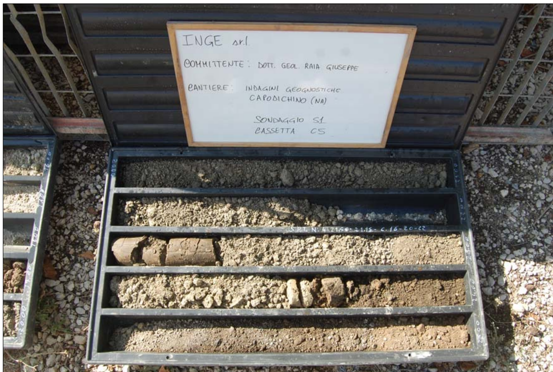
Sondaggio S1 - Cassetta C5
